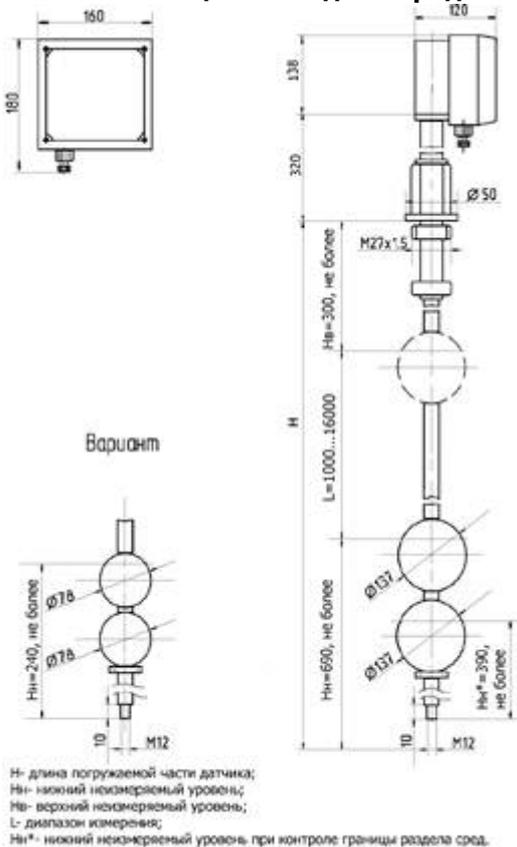
**Рис.3. Габаритные и присоединительные размеры преобразователя передающего (ППР)**
