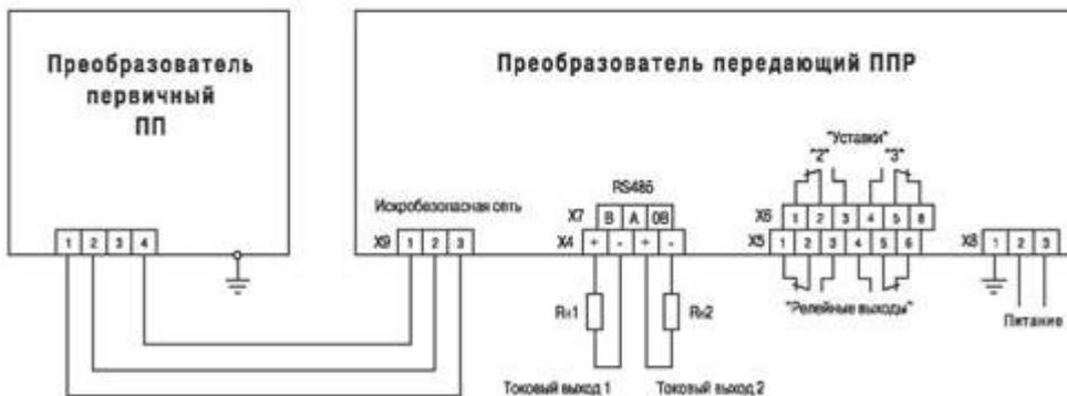
Линия связи  $R_{\text{доп}} < 20 \text{ Ом}$ ;  $L_{\text{доп}} < 0,5 \text{ мГн}$ ;  $C_{\text{доп}} < 0,1 \text{ мкФ}$
