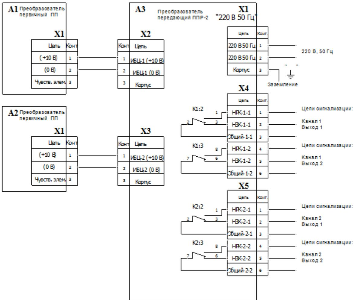
Рис. 6. Схема подключения двухканального сигнализатора (взрывозащищенное исполнение)
