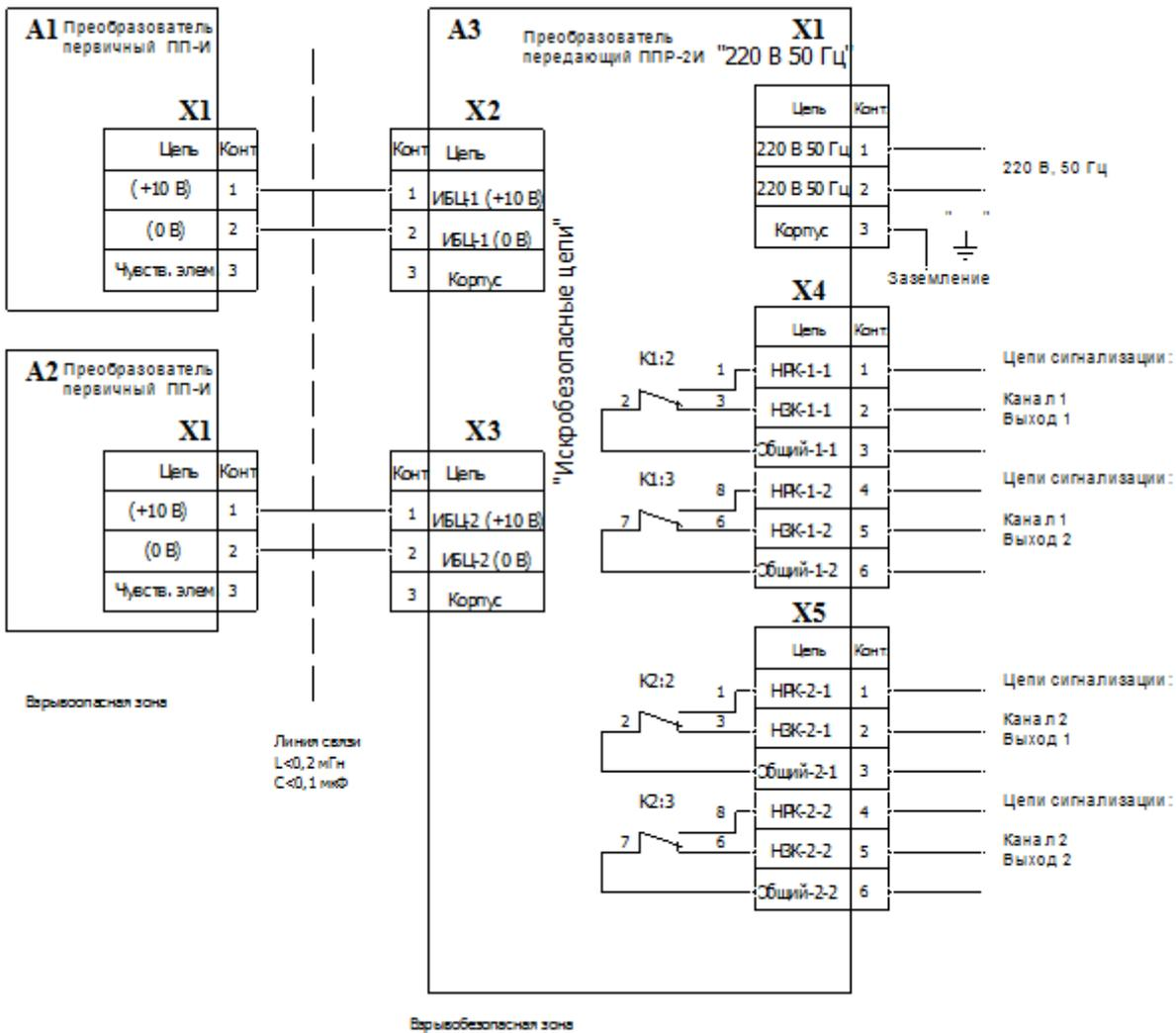
Рис. 7. Схема подключения сигнализатора с ПП-015И
