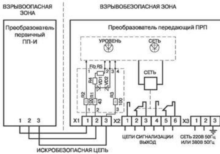
Для обеспечения инверсного релейного выхода поменять местами подключение выводов 1 и 3 ПП или использовать для подключения выходных устройств (цепи сигнализации) нормально замкнутые контакты выходного реле
