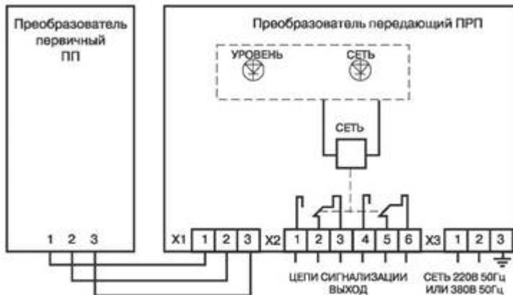
Для обеспечения инверсного релейного выхода поменять местами подключение выводов 1 и 3 ПП или использовать для подключения выходных устройств (цепи сигнализации) нормально замкнутые контакты выходного реле.
