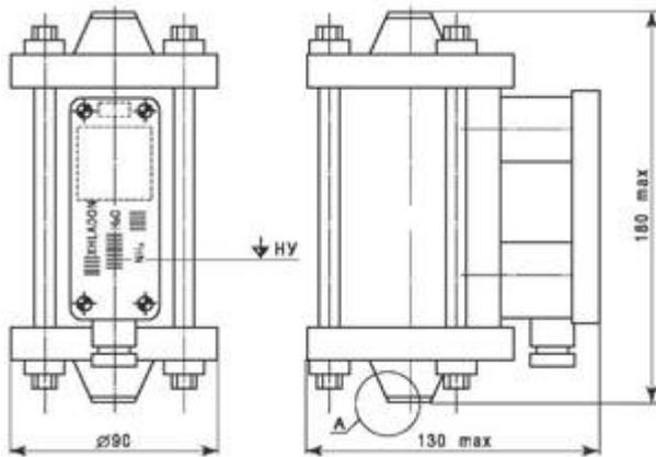
Рис. 2. Габаритные и установочные размеры передающего преобразователя
