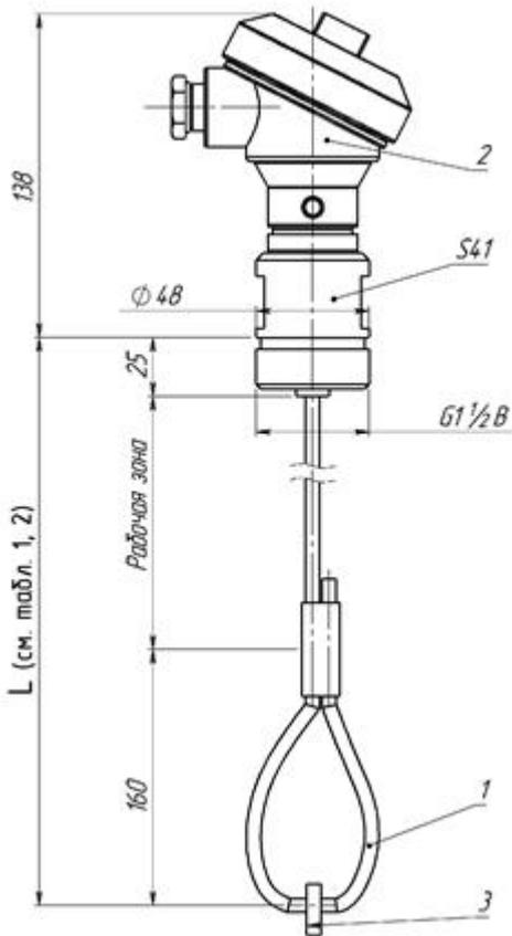
Рис. 2. Габаритные и установочные размеры преобразователя передающего
